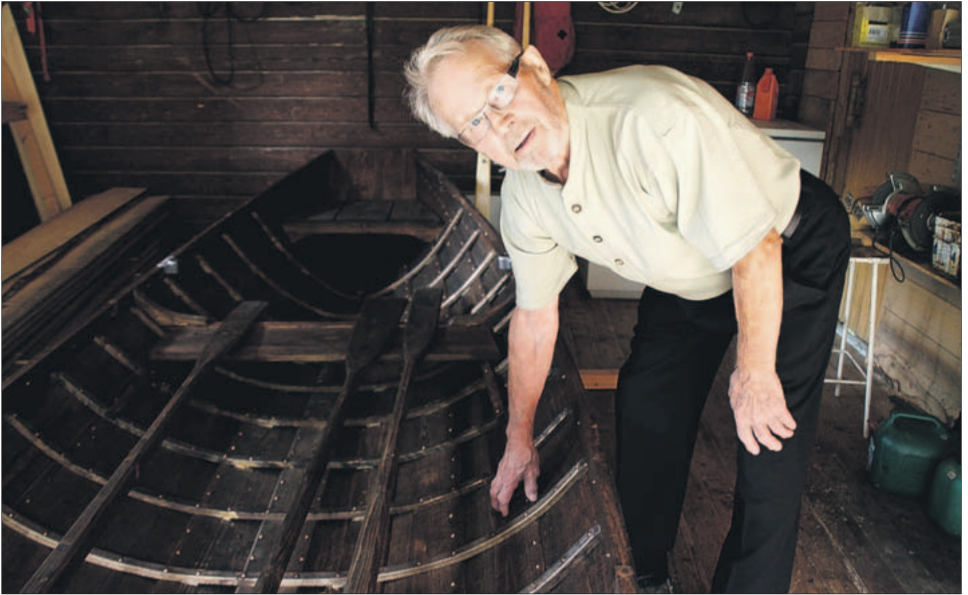
Sakari Räsänen valmistaa veneensä männystä ja kuusesta. Kaarten materiaalina toimii haapa. "Ennen tein ne saarnista, mutta se oli vähän liian kova puu", Räsänen selvittää.
